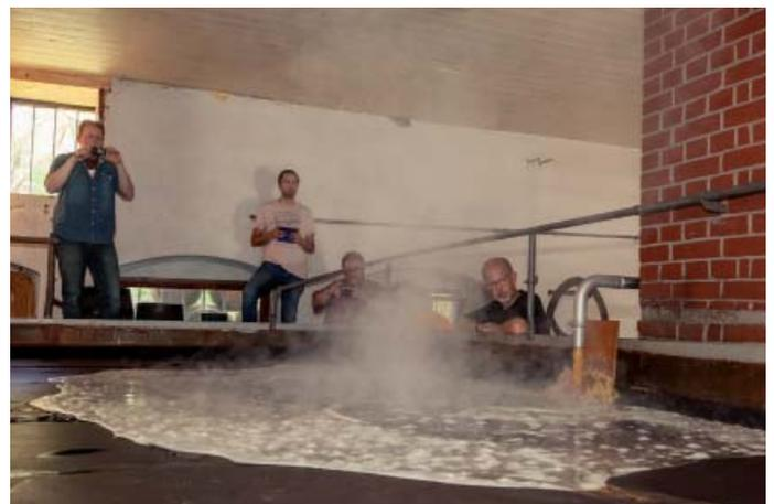
**Fast fertig: Nach dem Kochen läuft die heiße Würze auf das Kühlschiff**
