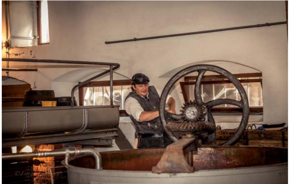
**Da kommt der Brauer ins Schwitzen: Das Hackwerk wird per Muskelkraft bedient**
