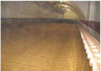
In einer kurzweiligen und sehr interessanten Führung zeigte uns der Betriebsleiter, Herr Karlauf, die Mälzerei entlang des Weges der Gerstenkörner – von der Annahme der Gerste über die Lagersilos, die Weiche, die Keimkästen, die Darre bis hin zu den Lagersilos des fertigen Malzes bekamen wir alles im Detail erklärt und – mit Ausnahme der laufenden Darre, dort wäre es etwas zu heiß gewesen – auch zu sehen.
